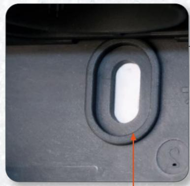
Étanchéité des puits de fixation de la boîte.
