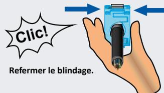
⑦ Clipser le guide câble sur le blindage fermé des prises RJ45 Cat6 ou 6A.
